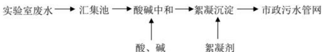
图 3-1 项目废水处理工艺流程
